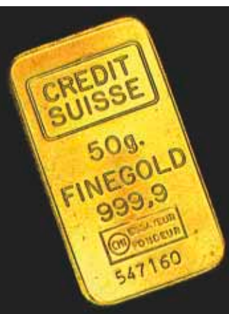
Gefälschte Goldbarren, aus Kupfer, lediglich vergoldet.
