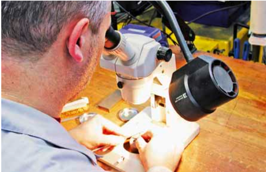
Die amtliche Punze, der «Bernhardinerkopf», wird im Zentralamt in Bern hergestellt (links die Matrise für die Herstellung der Punze).
